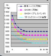
WPC処理®により、傾斜化された理想的な硬度変化に改善し、良好な耐衝撃性能が得られます。
